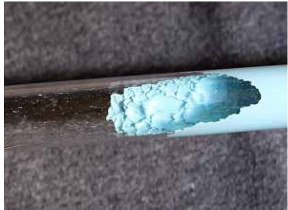
PermaProtect:s reliningprocess åskådliggjord genom ett glasrör. Reliningmaterialet appliceras i de befintliga rören med hjälp av tryckluft. Tjockleken på reliningen blir 0,5-1 millimeter.
